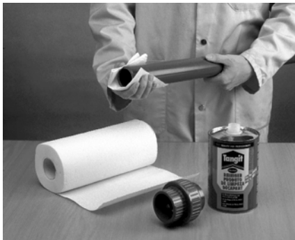
Reinigen von Rohr und Muffe
