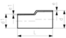
**SYGEF Plus Reduktion exzentrisch SDR21/PN16**
