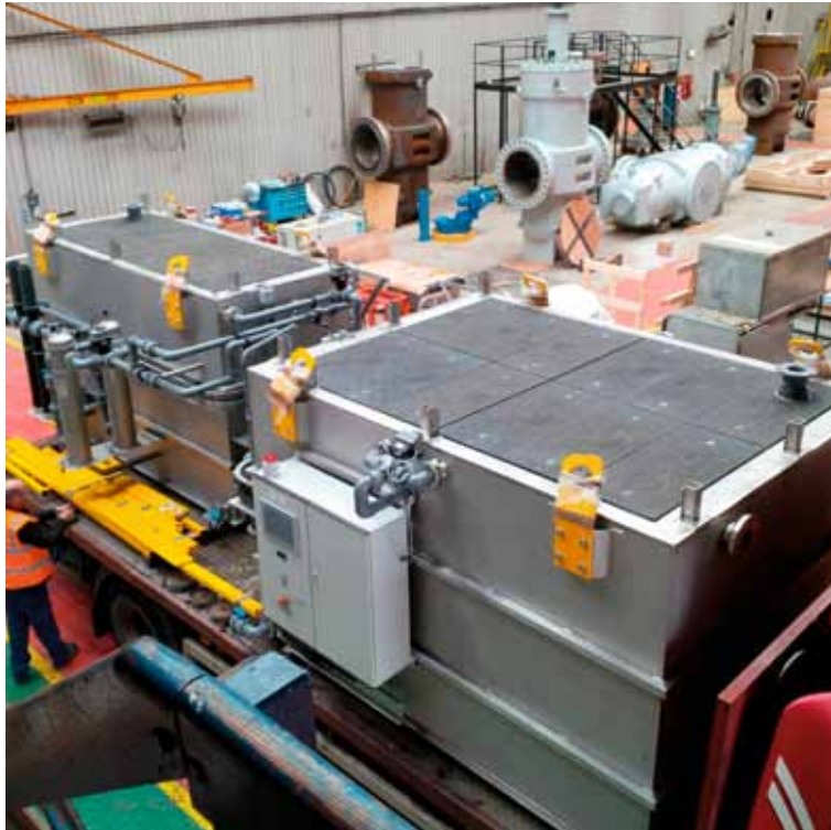
Klärbecken mit bereits verbauten Faserverbund-Reihenabdeckungen – beständig gegen die rauen Umgebungsbedingungen in der Antarktis
