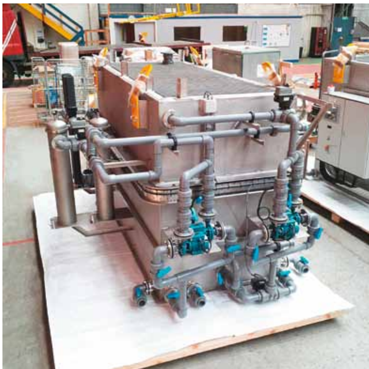
Klärbecken mit bereits verbauten Faserverbund-Reihenabdeckungen – beständig gegen die rauen Umgebungsbedingungen in der Antarktis
