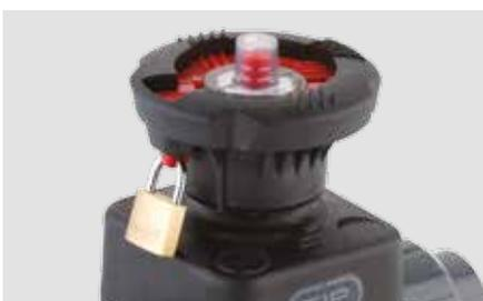
Um die Anlage zusätzlich vor unbeabsichtigten Manipulationen zu schützen, kann zusätzlich ein Vorhängeschloss angebracht werden, nachdem das Handrad in Blockierposition angehoben wurde
