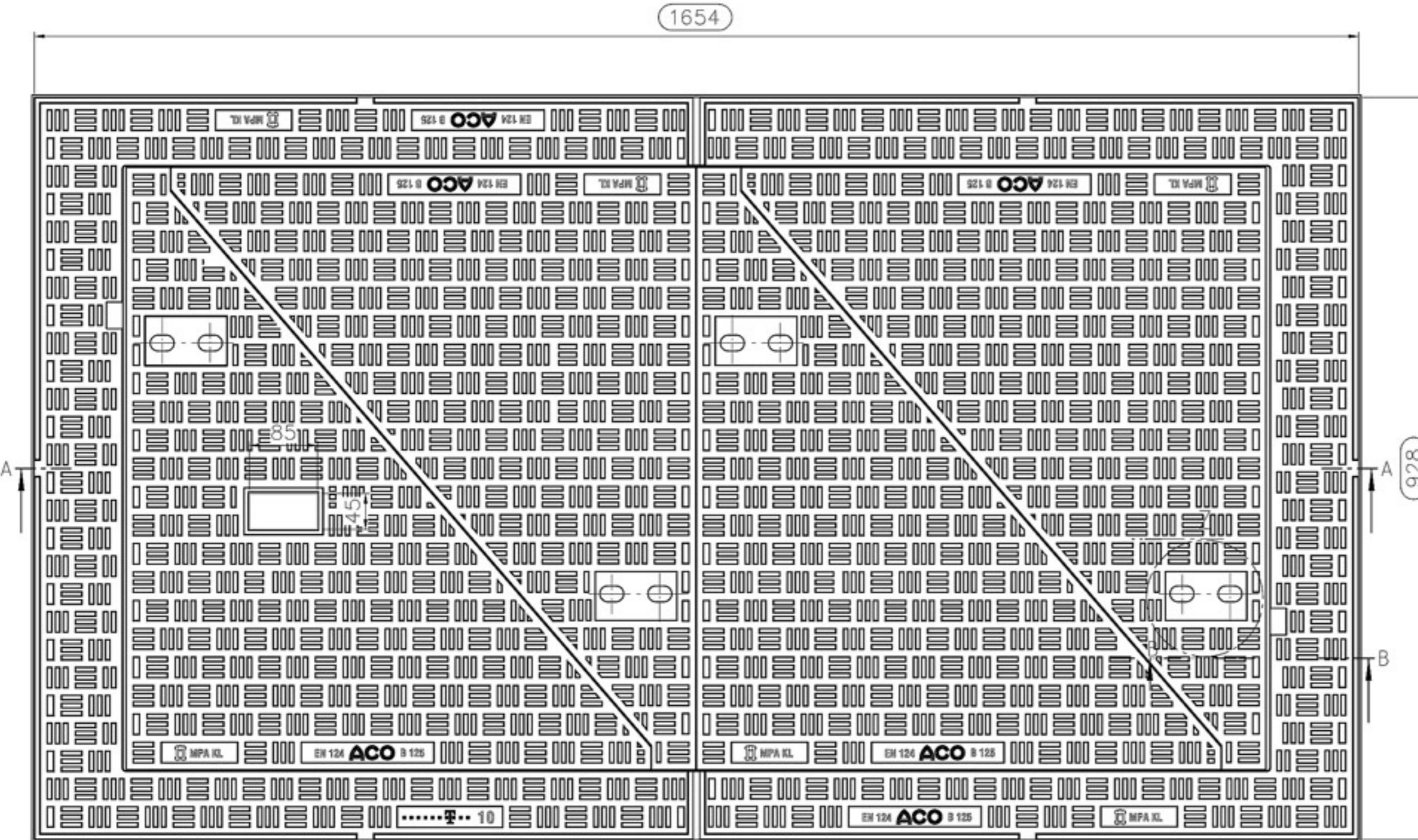
TRIGONA Kabelschachtabdeckung B125
