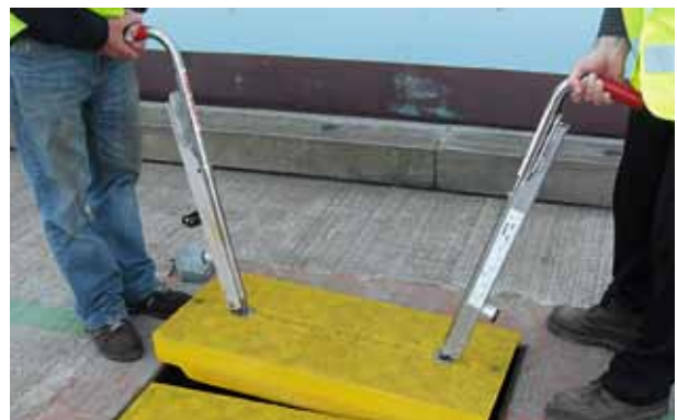
Einfaches und sicheres Herausheben mit dem speziellen Aushebewerkzeug
